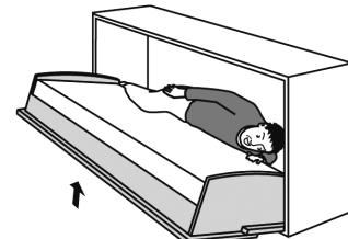
施工時にスプリングマットレスを載せた状態で質量バランスをとることで、適切な操作が可能になるよう設定されております。
