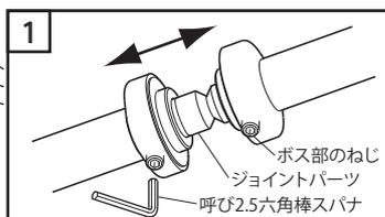
呼び2.5の六角棒スパナでボス部のねじを緩め、内部のジョイントパーツを取り出します。
