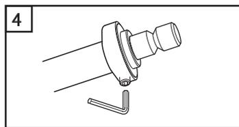
ボス部のねじをジョイントパーツの溝に合わせ、六角棒スパナで締め付けます。
