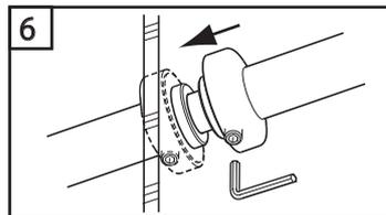
図の右側のドアハンドルをジョイントパーツに差し込み、ボス部のねじを六角棒スパナで締め付け固定します。
