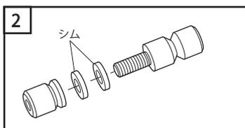
ジョイントパーツを分解し、ガラス厚に応じて、シムを外します。
