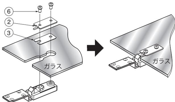
左図のように1でセットした丁番の上にガラスを置きます。その上から裏板パッキン③、裏板②、固定ねじ⑥の順でセットしねじを締めます。ガラス扉1枚に対して上下対称に2ヶ所にセットします。
