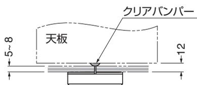
クリアバンパーを、閉止時に戸先に触れる天板部分および地板部分に付けます。
