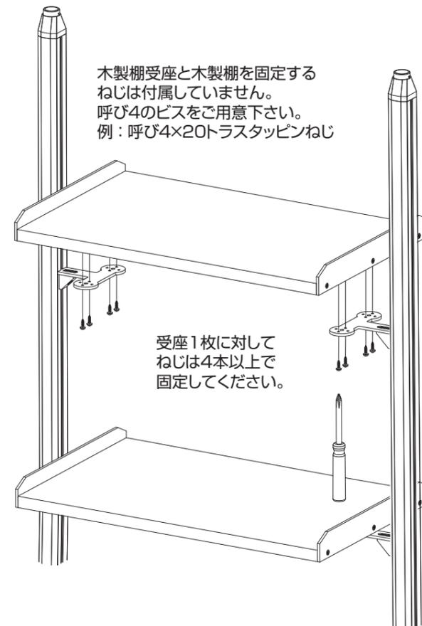
木製棚受座と木製棚を固定するねじは付属していません。呼び4のビスをご用意下さい。例：呼び4×20トラスタッピンねじ
