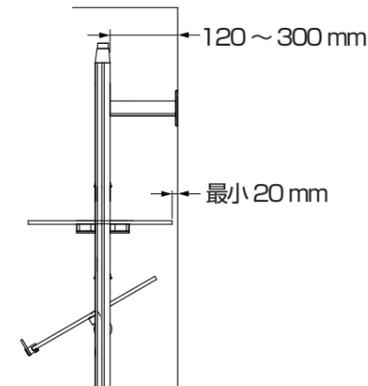
壁固定座縦フレームカットタイプ
