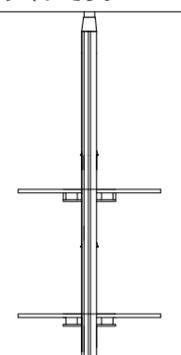
縦フレームの取り付けが天井床取付時はX寸法は自由に決めることができます。
