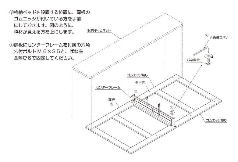
⑤扉板と枠板1~4のダボ穴に木工用接着剤を流し込み、図のようにダボを奥まで差し込んで組み立てます。
