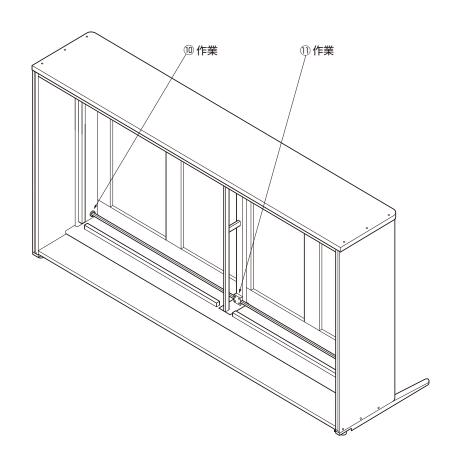
⑫裏面板の化粧面を内側(扉側)に向け、両左右側板の掘込部とアルミ脚後端の突起部との隙間に差し込んで裏面板が落ちないようにして、十字穴付なベタッピンねじ4×16で18箇所を固定してください。
