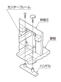
⑧ハンドル両端に樹脂製脚端を差し込み、扉内側から 十字穴付トラス小ねじM6×25で固定してください。
