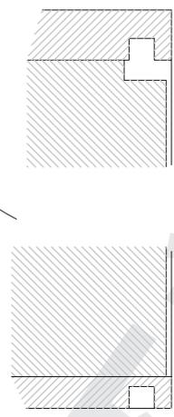
中仕切板を設ける場合、寸法図に従い、切り欠きを設ける。
