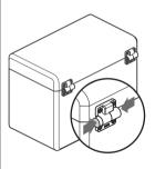
トルク低下が生じた場合、トルクを再調整 してください。
