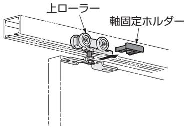
② 扉が上レールと平行で床面とのすき間が 6 ~ 14 mm になるように調整する。
