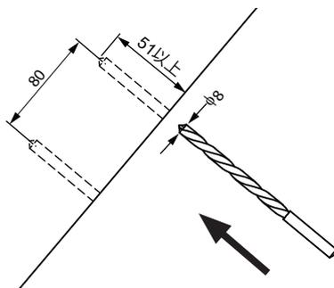
3. アンカーを打ち込み、皿木ねじをねじ込む。
