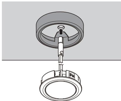
(4) LEDをサーフェスマウントリング(別売品)に最後まで押し込み、固定する。
