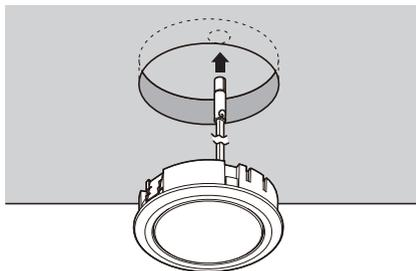
(3) LEDを取付穴に最後まで押し込み、固定する。
