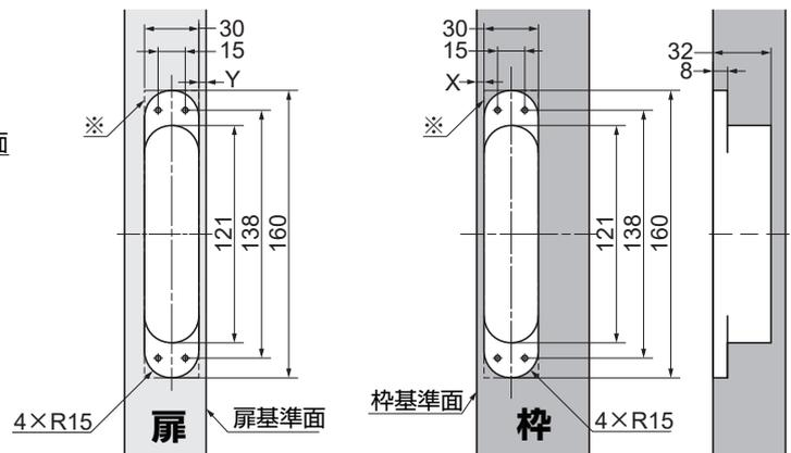
※オプション品の角型ねじカバーを使用する場合は、扉・枠ともに一段目の長円穴の掘り込みを幅 30 × 長さ 160 × 深さ 8 の四角穴で設定してください。
