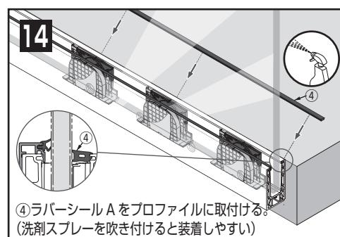
オプションのエンドキャップを使用する場合…④ラバーシール A をアルミプロファイル長さより 4 mm 短くする。（P.9 参照）
