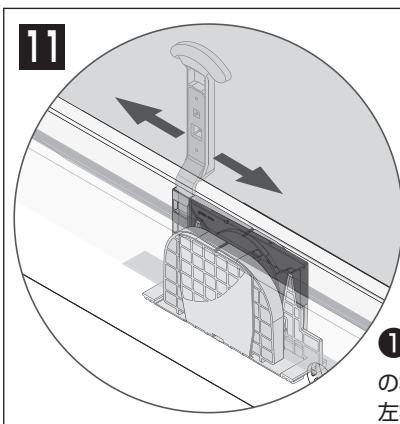
① ⑥取付工具を⑨で抜いた「押さえシート」の場所に差し込む。② ②セッティングブロックを左右に動かし、ガラスを垂直にする。
