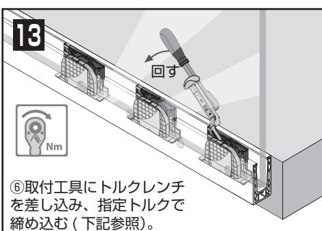
⑥取付工具にトルクレンチを差し込み、指定トルクで締め込む（下記参照）。
