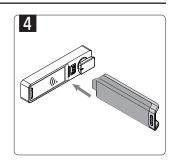
プログラムキーを挿す。 → 2トーンの電子音が1回鳴り LEDが消灯すれば完了。
