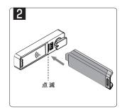
2トーンの電子音が聞こえたら、プログラムキーを抜き、 すぐに再度挿す。
