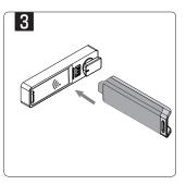
プログラムキーを挿す。 → 2トーンの電子音が鳴り、 LEDが消灯する。
