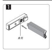
プログラムキーを挿す。 → 2トーンの電子音が鳴り、 LEDが点灯する。
