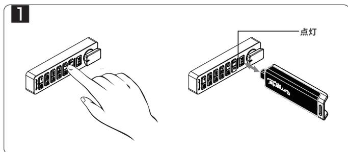
$\text{C} + \text{On} + \text{5} + \text{5} + \text{On}$  を押す。→ LEDが点灯する。
