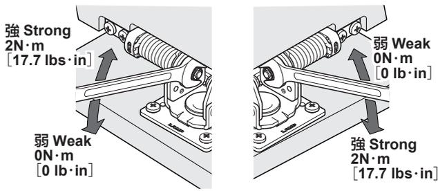
調整ナットを時計回りに締めることでトルクを強くできます。
