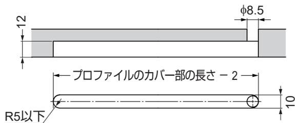
(1) プロファイルを加工する (切断、切欠加工)。
