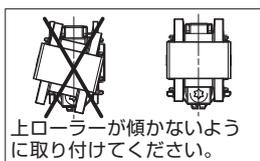
2. 付属工具④を使い、上ローラーと本体を取付ねじ④で固定する。
