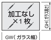
$$GH(\text{ガラスの高さ}) = \frac{TH-104-(\text{中棧の数量} \times 11)}{\text{ガラスの枚数}}$$
