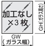
$$GH(\text{ガラスの高さ}) = \frac{TH - 104 - (\text{中棧の数量} \times 11)}{\text{ガラスの枚数}}$$
