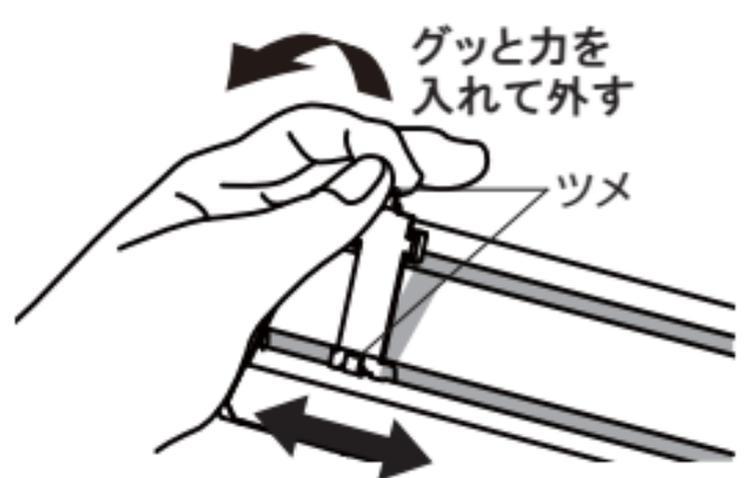
**3** 穴に合わせて取付金具の位置を調整する。左右の穴で、ツメを入れる位置を揃える。
