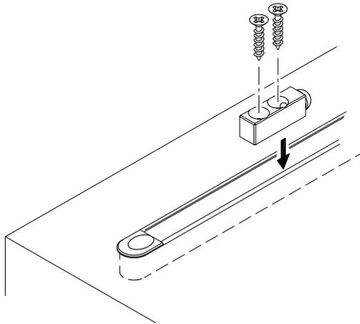
※ P3の部品構成図を参考にし、扉を止めたいところに下ストッパーを取り付けてください。
