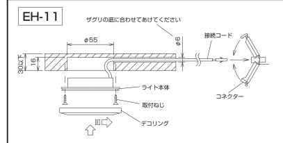
ハロゲンライトを取り付ける場所にφ55、深さ16のザグリ穴とφ6の横穴をあけ、先に接続コードを横穴に通してからライト本体を付属の取付ねじ3本でしっかり固定します。 次にガラスカバーをライト本体にはめ、右に回して固定します。接続コードは先端の端子をコネクターにいっぱいに(端子の先端がコネクターから出っ張るように)差し込み、パチンと音がするまでコネクターを閉じてください。
