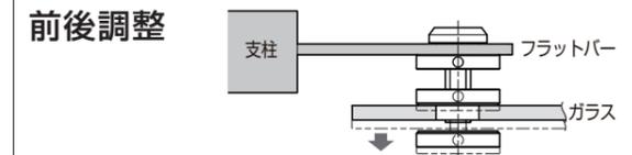
① キャップを緩める ② ナットを回し、ガラスと共に前方向へ動かし調整する
