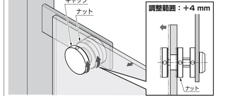
※ガラスが重く、ナットが回せない場合は、ガラスを持ち上げ少し浮かせて作業をしてください。
