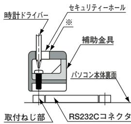
1.パソコン本体裏面のRS232Cコネクタ取付ねじ部の片側に合わせ、コネクタを挟み込んだ状態に補助金具を被せセキュリティホール上部より時計ドライバーにてねじ [十字穴付なべ小ねじ4-40(l=8)インチサイズ] をねじ込み補助金具を固定します。
