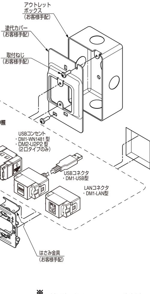
本製品をプレート取付枠（別売品）の正面から「パチン」と音がするまで押し付け、取り付けてください。
