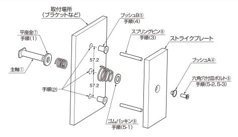
(1)取付場所の板厚が9.5mmより薄い場合、補正をして9.5mmに近づけてください。
