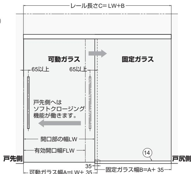
※2 上レールカバー、下レールと固定ガラスの固定はシーリング材などを使用してください。
