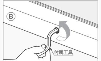
ピボット軸をクローザー穴から抜きます。
