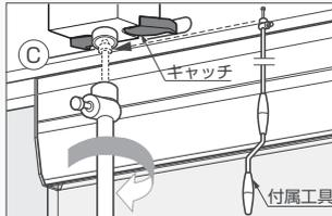
付属工具で約6回転させ、上ローラーをキャッチでしっかり挟みます。
