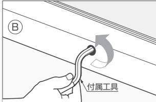
ピボット軸を出し、クローザー穴に突き当てます。付属工具を使い、左に回し、(約10回転)重くなったところで更に1/4回転、回します。5~6回転で、重くなる時は、クローザー穴に入っていないので、やり直します。
